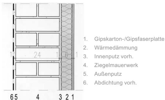
Abb. 54 Kelleraußenwand mit innenseitiger Gipskarton-Verbundplatte
