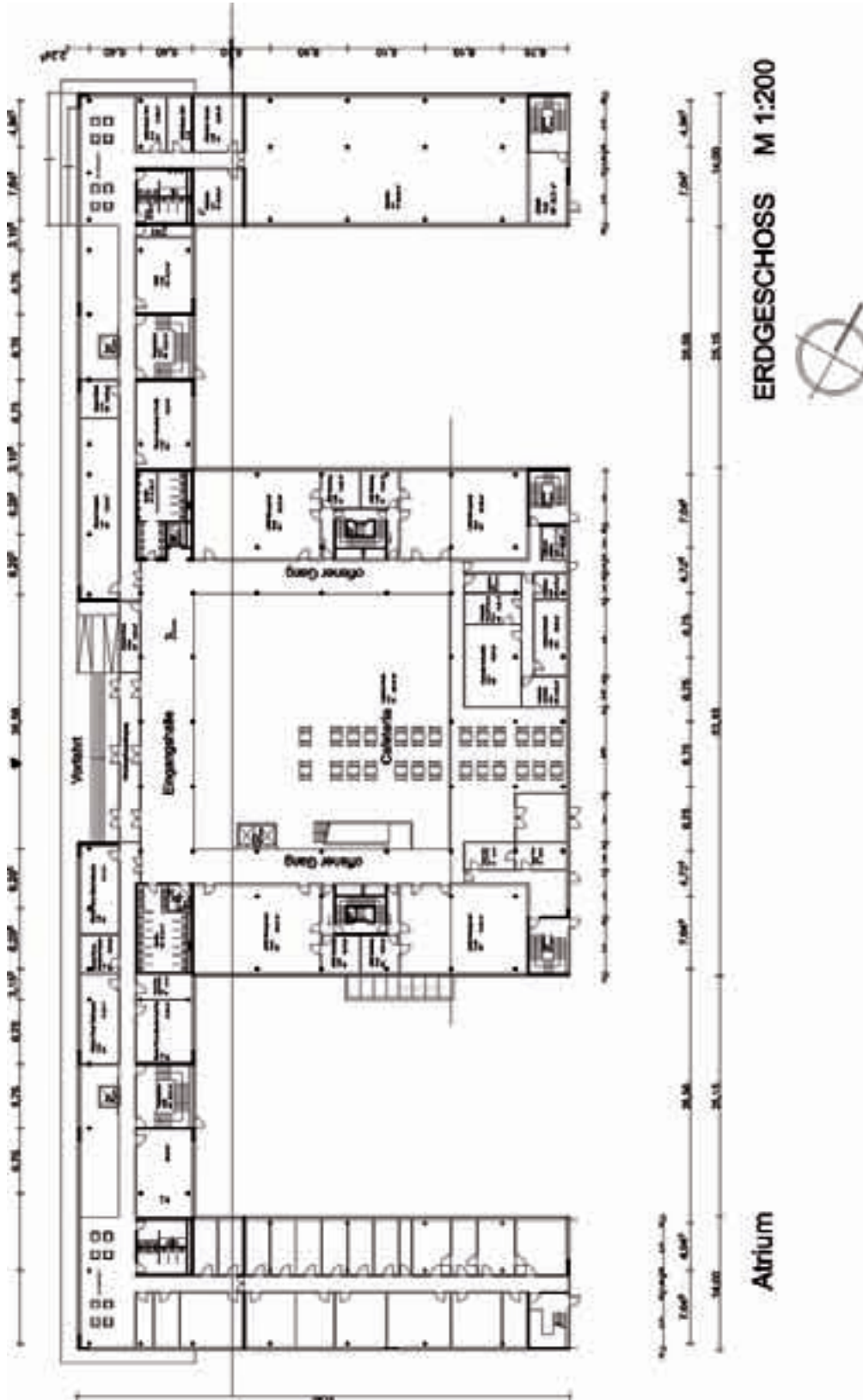
Bild 4.3-1: Grundriss Erdgeschoss Verwaltungsgebäude
