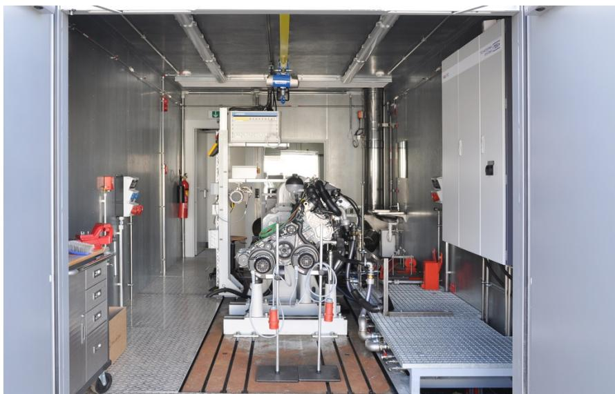
Motorenprüfstand (Foto: Roth / Stbaab)
